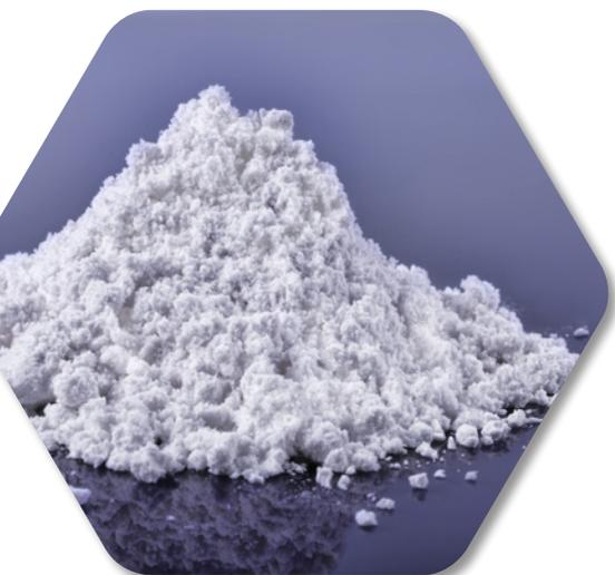
Le trihydroxide d'aluminium (ATH) est une charge minérale non halogénée présentant des propriétés ignifugeantes. La décomposition, sous l'effet de la chaleur, de l'ATHs'effectue à partir de 200°C, seuil auquel il perd trois molécules d'eau. La réaction endothermique absorbe la chaleur environnante ralentissant ainsi la propagation du feu.
